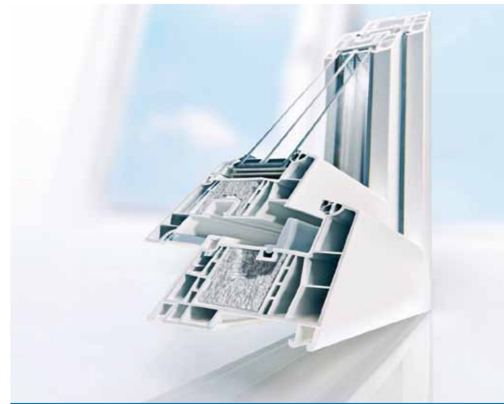
Šešių kamerų, 86 mm pločio profilio langai su trigubų stiklų paketais atitinka A energijos taupymo klasę, įvertinus šilumos perdavimo koeficientą. Pateikti standartinio 1 230 x 1 480 mm lango dydžio duomenys. U (stiklo) vertė = 0,5 W/ kv. m K U (rėmo) vertė = 0,91 W/ kv. m K Bendra U (lango) vertė atitinka pasyviosios energijos namo rodiklį = 0,73 W/kv. m K
